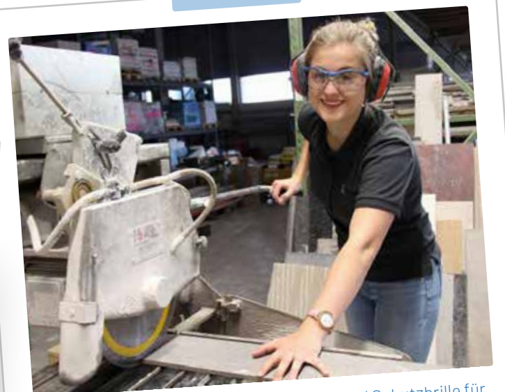
Beim Fliesenschneiden sind Gehörschutz und Schutzbrille für Franzi selbstverständlich.
